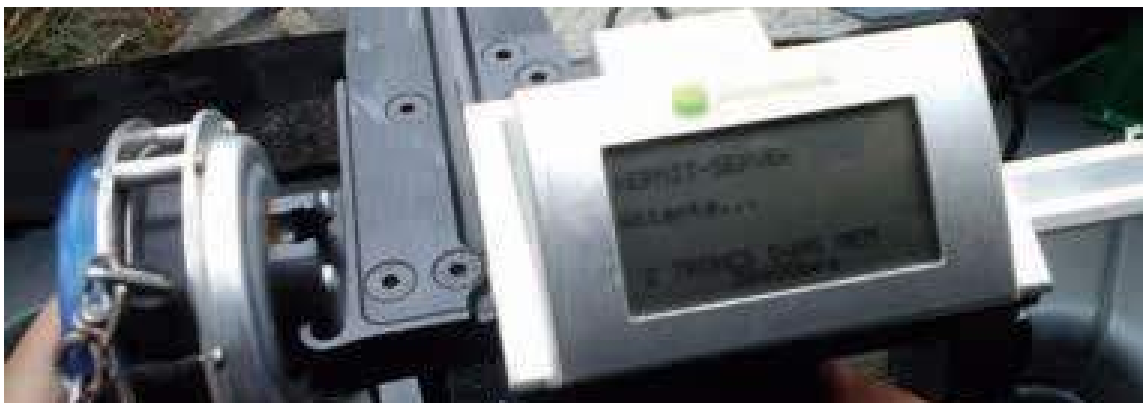
Exemple de compas électronique. L'opérateur vérifie après la synchronisation que les 2 troncs sélectionnés pour le contrôle sont bien enregistrés dans la mémoire de son compas.
