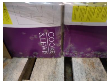
Photo 3: développement de moisissures dans un container maritime
