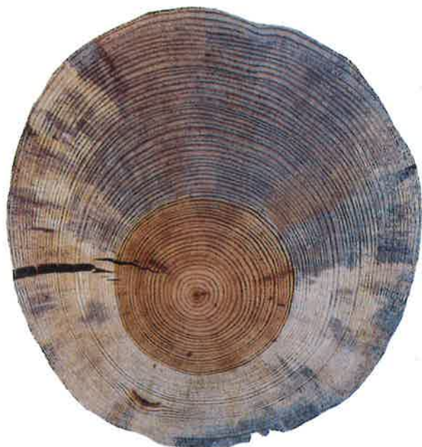
Photo 1 - Section transversale de pin sylvestre dont l'aubier est bleui. Cliché CTBA (D. DIROL)
