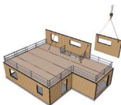
15 Avancement du bâtiment avec retrait au fur et à mesure des protections collectives
