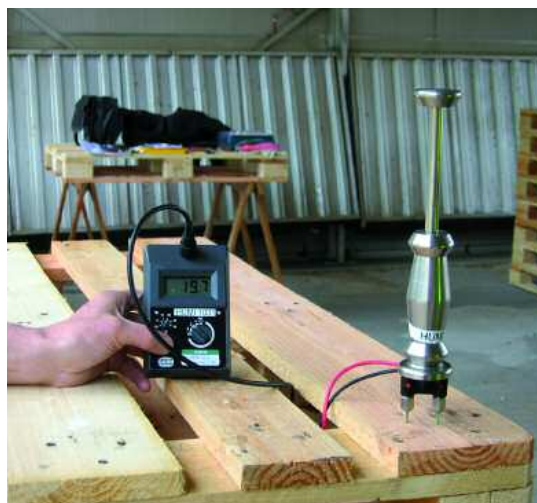
Mesure de l'humidité d'une palette avec un humidimètre à pointes
