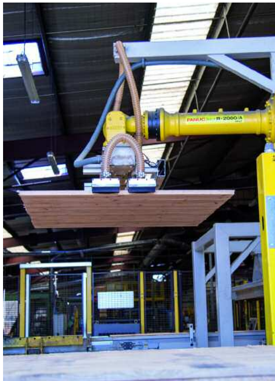
Dépilage automatique de sciages à palettes
