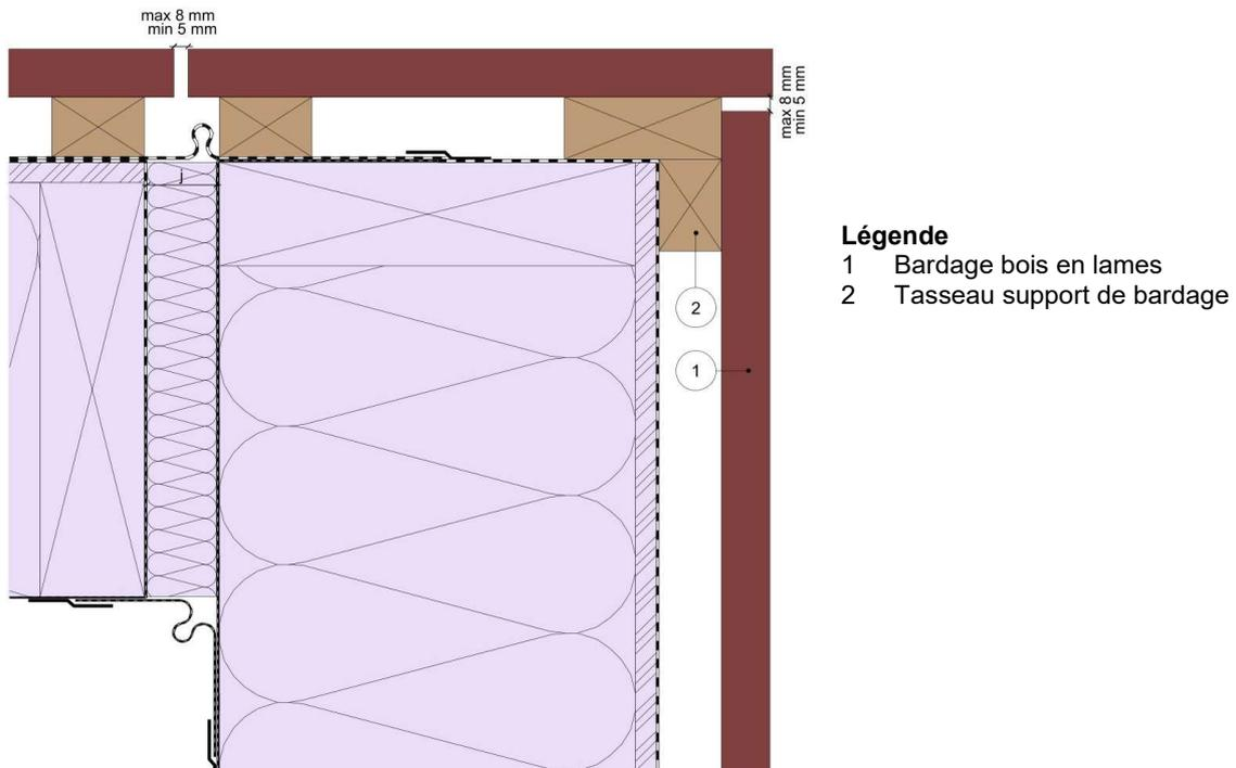
Figure 13.1 Exemple de joint ouvert à la jonction entre deux FOB en angle sortant (avec joint creux)
