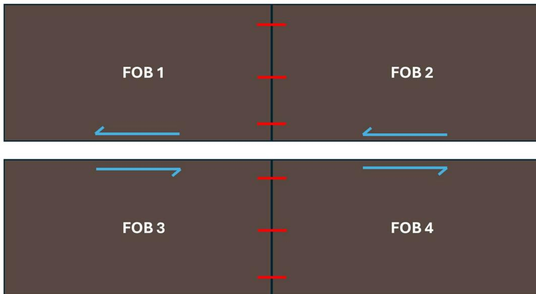
Figure 8 : Illustration de FOB liaisonnées mécaniquement verticalement
