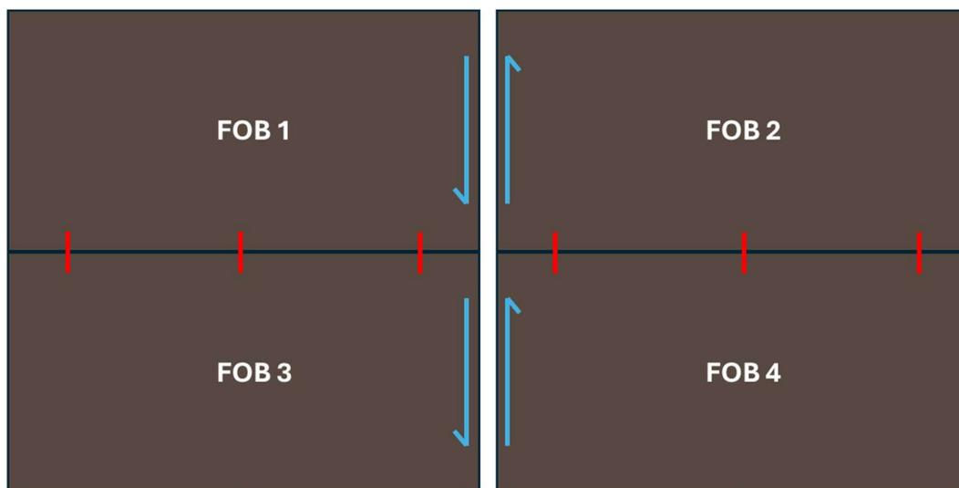
Figure 9 : Illustration de FOB liaisonnées mécaniquement horizontalement
