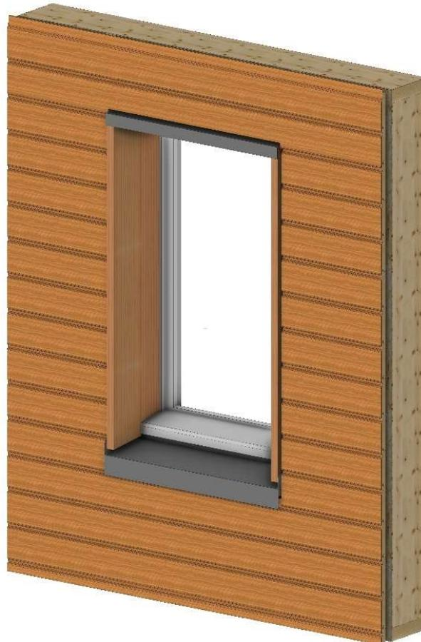
Figure 19 Exemple de mise en œuvre avec encadrement en bois – vue de face
