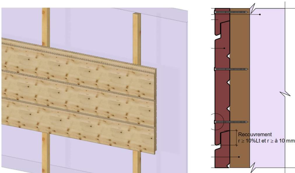
Figure 6 : Lames à mi-bois – pose horizontale (illustration 3D et coupe verticale)
