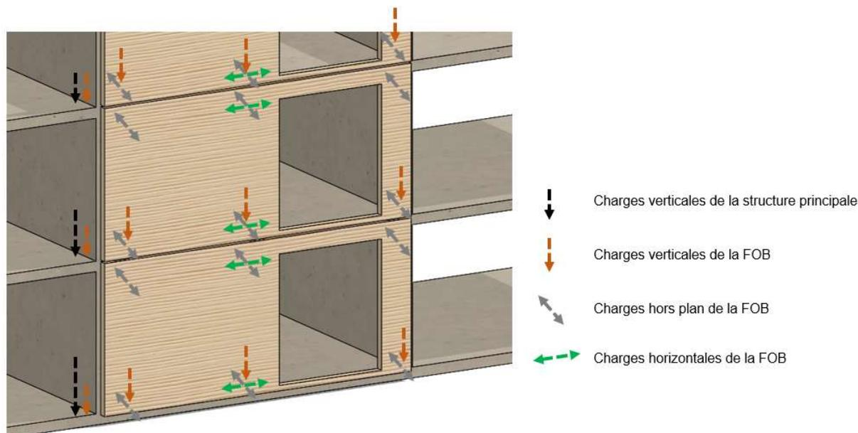
Figure C : Illustration d'une FOB filante posée avec appuis multiples
